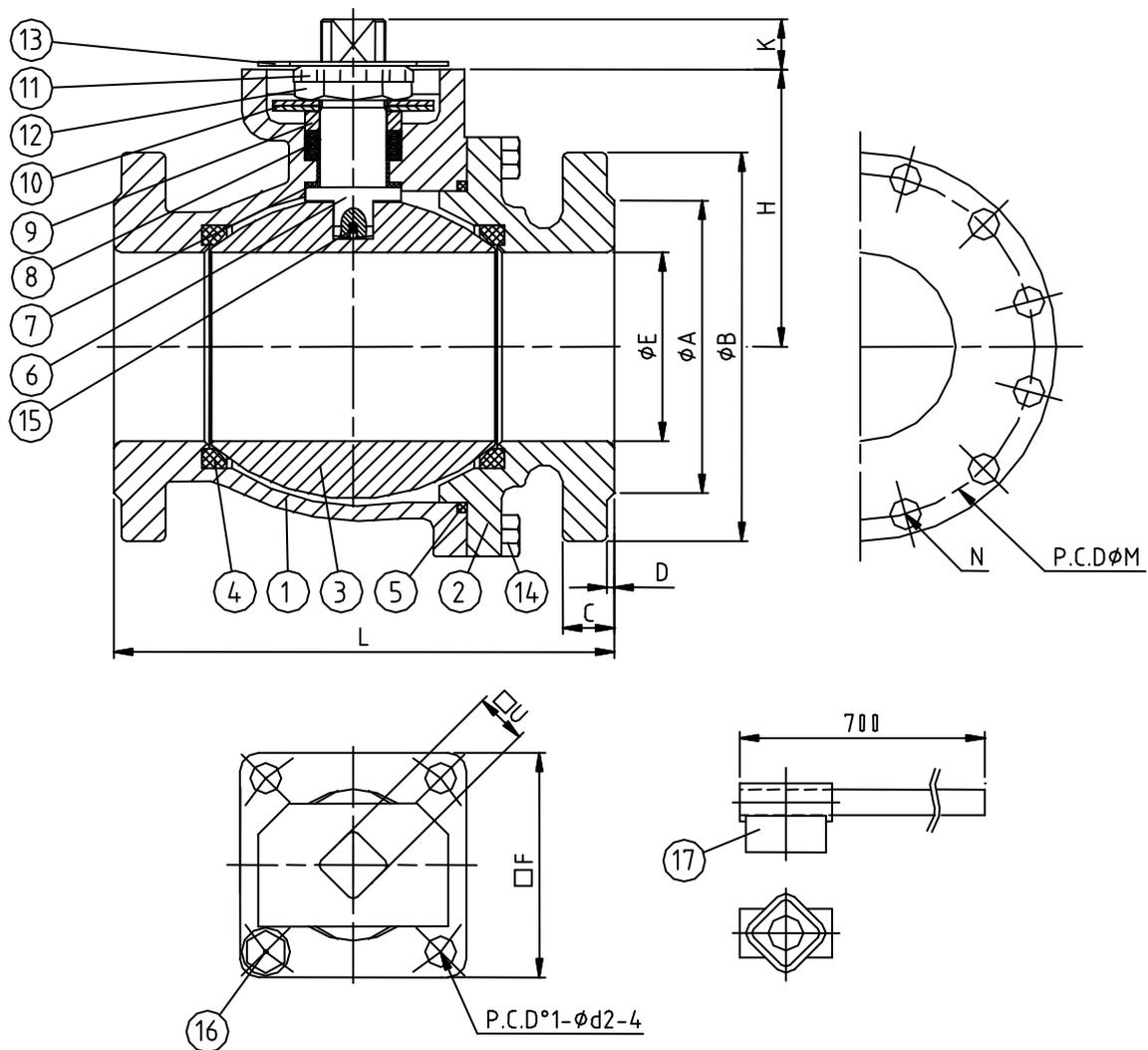
Integrierter DIN/ISO 5211 Aufbauflansch für direkten Antriebsaufbau
